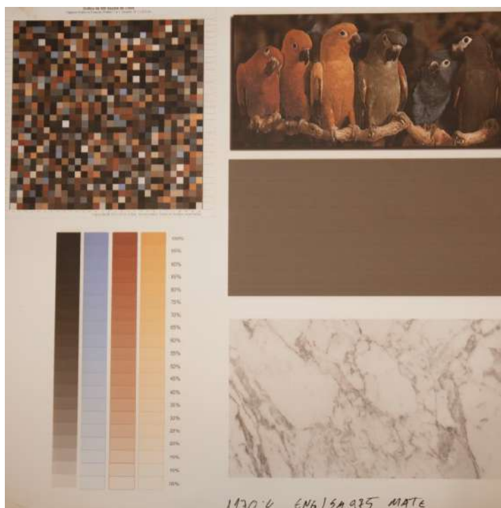
Figura 14 – Teste 1170 °C esmalte mate. Fonte: do autor, 2018.
